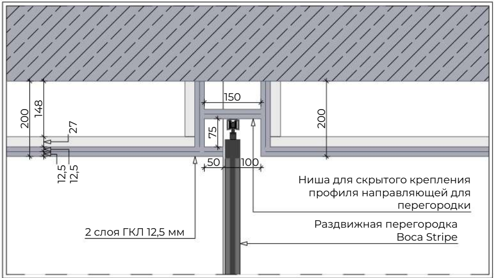
C-C Разрез потолка C-C 1:10
